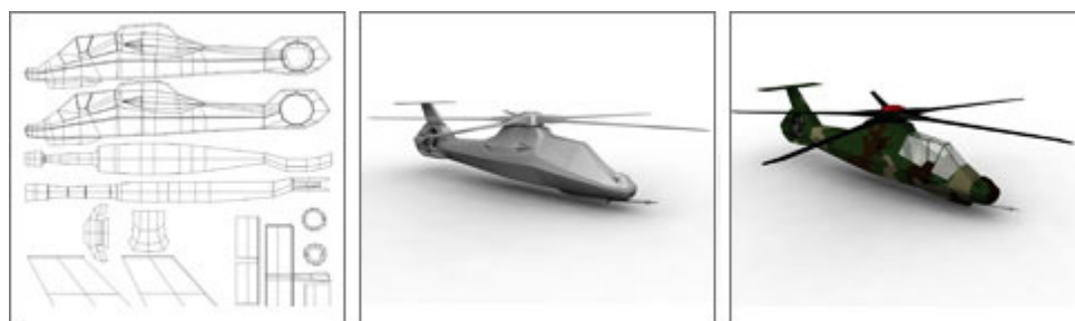
Figuur 3-3 - Het proces van een 3d-draadmodel naar een volledig gerenderd 3d-object (Bron: www.josh-lynch.com )
